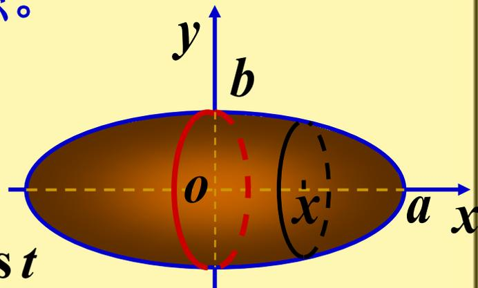
例7. 椭圆  $\frac{x^2}{a^2} + \frac{y^2}{b^2} = 1$  所围图形分别绕  $x$  轴、
